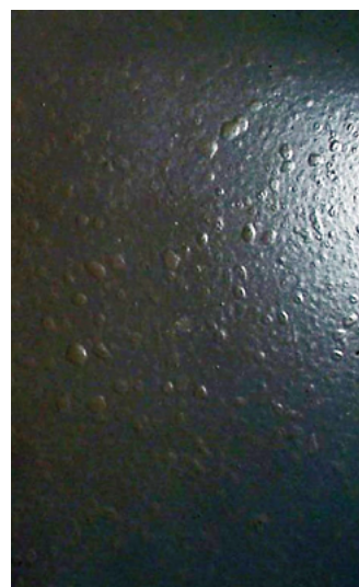
Figura 3: Exemplos de coágulos causados pela má-dispersão de resina e da pasta ao banho de e-coat
