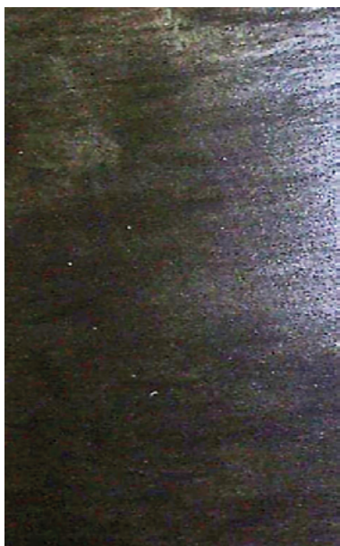
Figura 4: Exemplo de painel pintado com baixa camada (6 µm) de e-coat. As ‘manchas’ claras indicam que o substrato não está visualmente oculto pela tinta (cobertura insuficiente)
