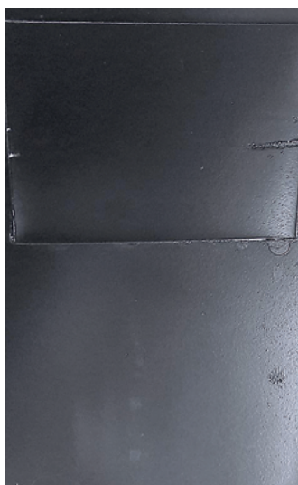
Figura 6: Exemplo de escorrimento entre sobreposição de chapas. Os escorridos são mais intensos no lado direito da junção
