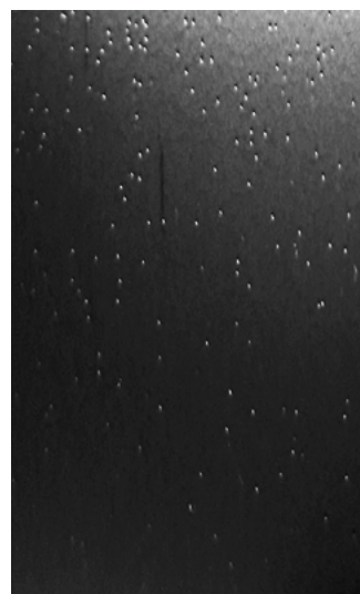
Figura 7: Exemplo de painel pré-revestido (galvannealed), o qual foi submetido à tensão alta o bastante para causar dezenas de pinholes
