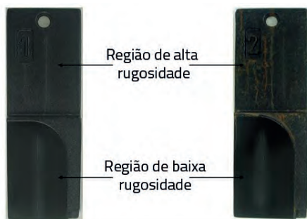
Figura 3: Comparação entre regiões de alta e baixa rugosidade em dois produtos diferentes. À esquerda, sistema com alta proteção de bordas, à direita, produto convencional. Nota: há cortes esclerométricos em duas regiões distintas de cada peça.
