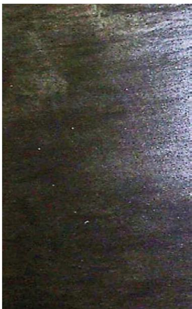
Figura 4: Exemplo de painel pintado com baixa camada (6 µm) de e-coat. As ‘manchas’ claras indicam que o substrato não está visualmente oculto pela tinta (cobertura insuficiente)
